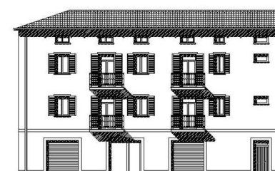
- sostituzione delle tapparelle con scuri; - applicazione di mensole nei balconi e trattamento della soletta; - rimozione dell'arenaria a piano terra; - sostituzione dell'aggetto in cemento armato con cornici; - aggiunta di cornici a finestre e aperture a piano terra.
