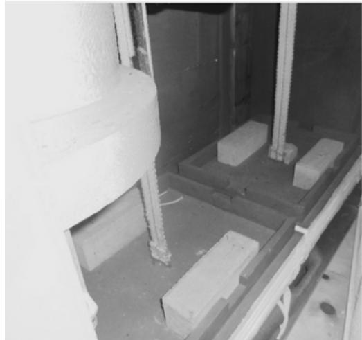
Figura 7 Mantici a lanterna per l'immagazzinamento e la messa in pressione dell'aria fornita dall'elettroventilatore (primo piano). I mattoni sopra i mantici determinano il livello di pressione dell'aria. I nastri di corda attaccati ai mantici permettevano e permettono tuttora di alimentare l'organo manualmente mediante due corde che sono posizionate sul fianco destro dell'organo.
