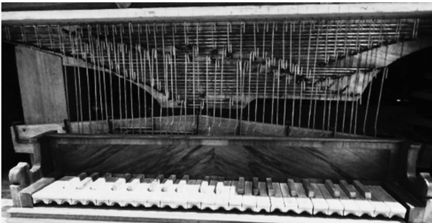
Figura 4 Catenacciatura dell'organo. Ogni tasto è collegato attraverso una serie di leve e rimandi in acciaio al rispettivo ventilabro. Questo tipo di trasmissione permette all'organista di modulare con precisione l'attacco dei suoni. Relativamente alla tastiera si noti la prima ottava corta nel registro più grave.
